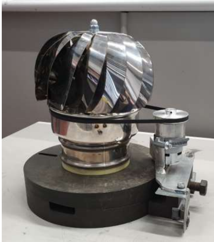
Figura 26: assemblaggio puleggia sul prototipo 0.
