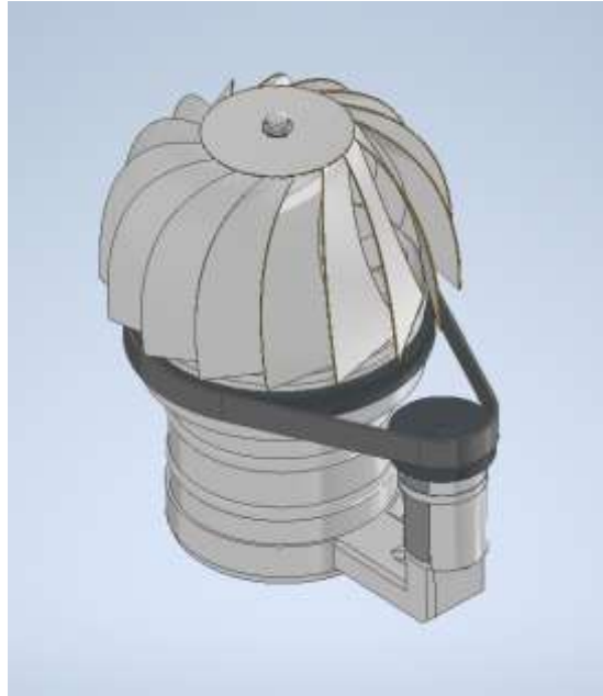
Figura 23: assieme comignolo-motore. "Prototipo 0" realizzato con software di modellazione 3D Autodesk Inventor.
